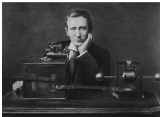
Рис. 4. Искровой передатчик Г. Маркони (1901 г.). С помощью такого передатчика был послан сигнал SOS с гибнущего «Титаника»
